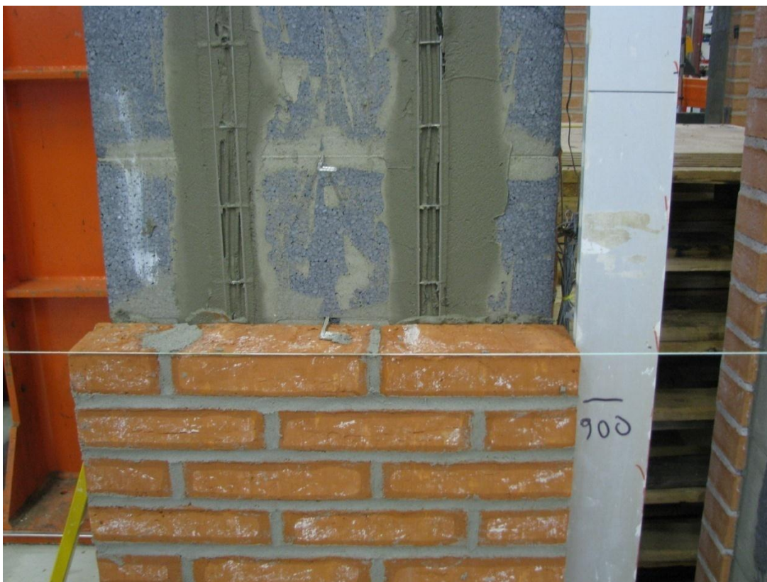
Fig. 18. På EPS påføres Multiklæb i baner, som armeringen presses ind i.
