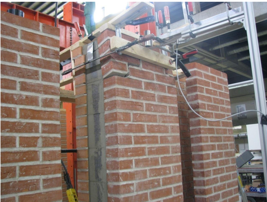
Fig. 5. Forskydningsbrud i top
