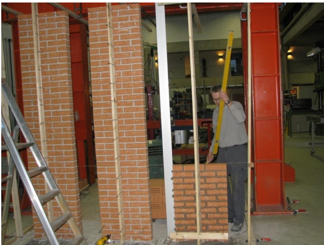
Fig. 11. Bagmuren er færdigmuret og hærder af
