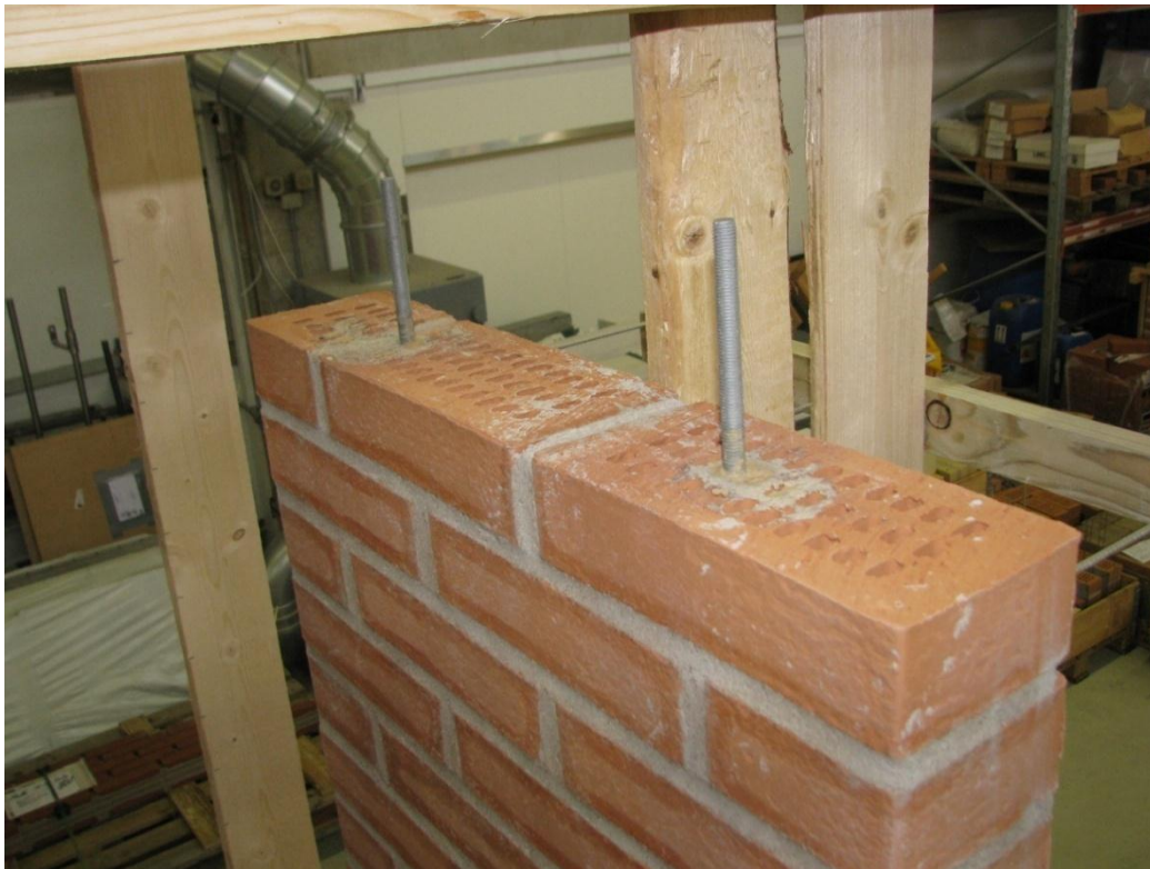
Fig. 12. I top er indlimet 2 gevindstænger i de øverste 3 skifter. Mange forskellige løsninger kan anvendes ved forankring af toppen
